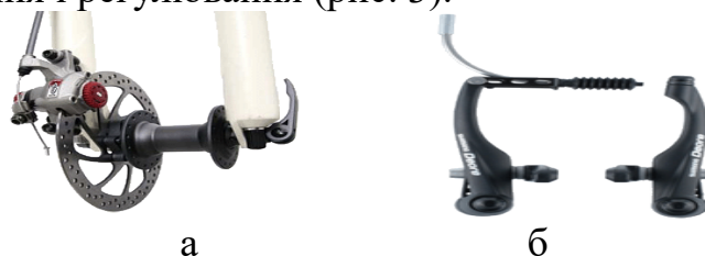
Рис. 3. Два типи гальмівної системи на велосипеді (а – диск; б – V-брейк)
